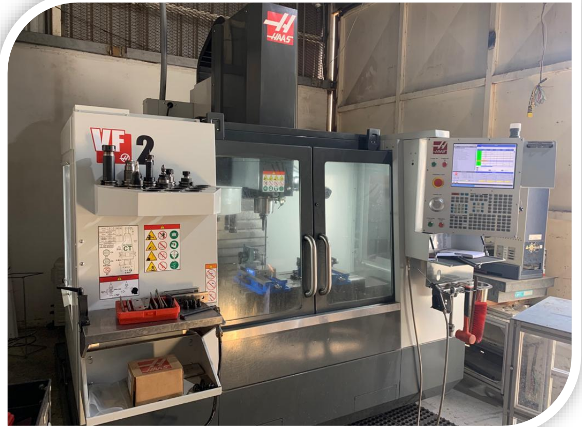
CENTRO DE MAQUINADO HASS VF2 X ; 30" Y ; 16" Z ; 20"
