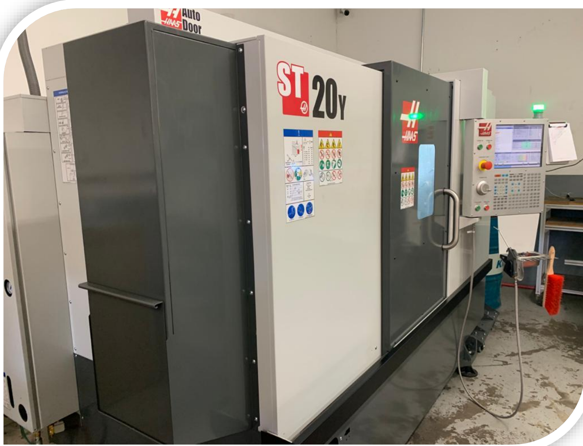
CENTRO DE TORNEADO HASS ST20Y TORNEADO MAXIMO DIAMETRO DE CORTE : 13" MAXIMO DIAMETRO VOLTEO 21 " MAXIMO LARGO DE CORTE 22.50"
